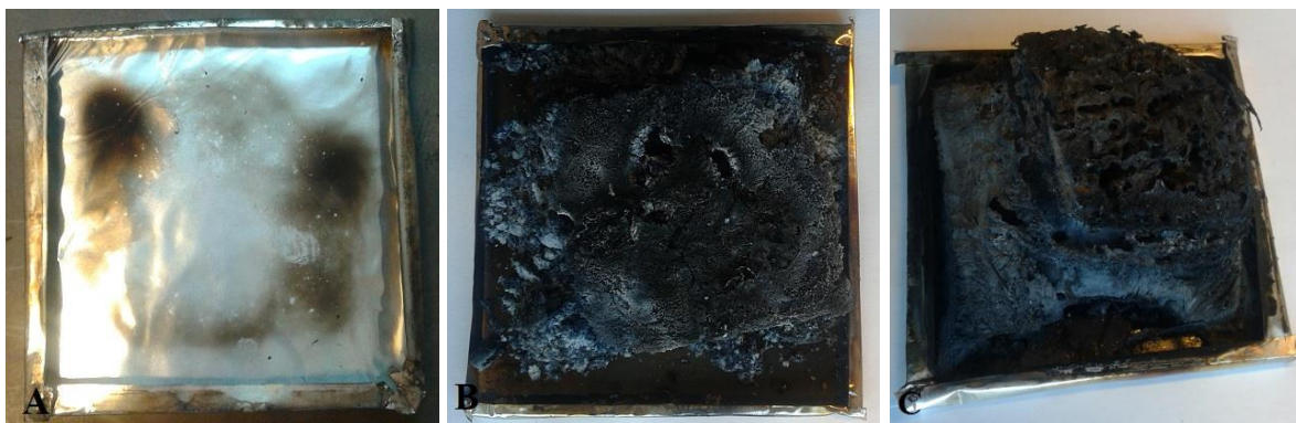
Rysunek 2. Zdjęcia pozostałości po badaniu wykonanym za pomocą kalorymetru stożkowego dla niemodyfikowanego HDPE (a), polimeru z niepalniaczem halogenowym (b) oraz jednym z opracowanych układów niepalniających (c) (zdjęcia K. Sałasińska)
