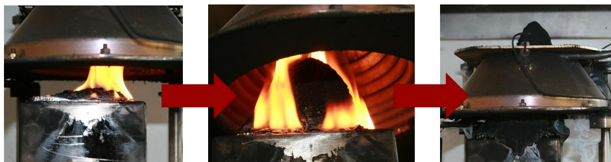
Rysunek 3. Zdjęcia obrazujące przebieg badania palności za pomocą kalorymetru stożkowego wykonane dla polimeru modyfikowanego opracowanym układem uniepalniającym spęczniającym (zdjęcia K. Sałasińska)
